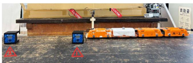
う、雑巾を用いて勢いを吸収し、台車が止まった後に重りの位置ずれを計測した。
